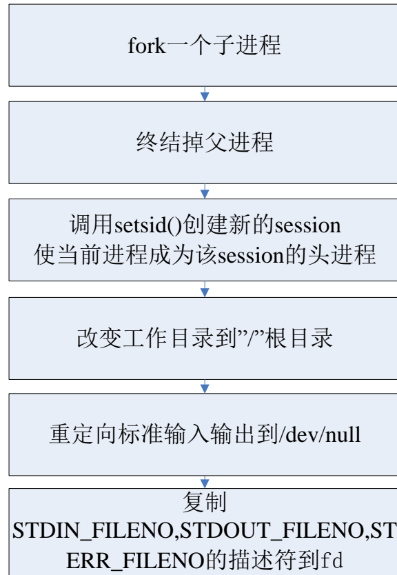
Memcached守护进程处理流程图
